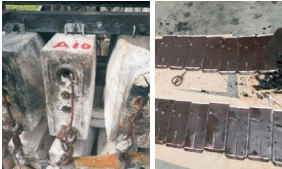
图 15 A10 电容器解体 Fig. 15 Disassembly of A10 capacitor
