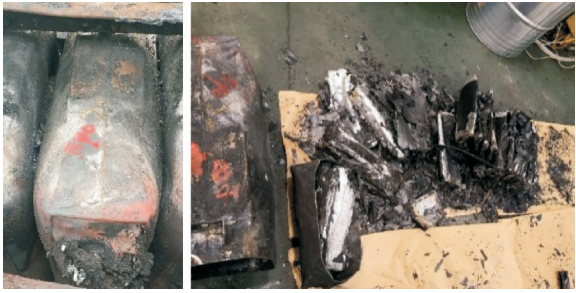
图 14 B40 电容器解体 Fig. 14 Disassembly of B40 capacitor
